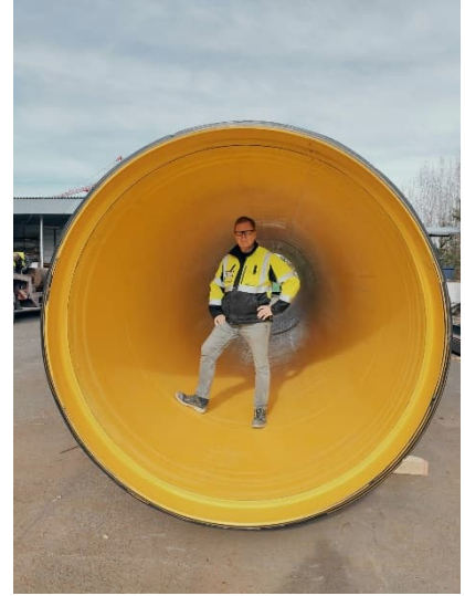
Kuva 9. Vasen kuva kahdesta 6 m pitkstä, yhteen hitsatusta purkuputken osasta, joista purkuputki kootaan. Oikeassa kuvassa Projektipäällikkö Ari-Matti Ilkka seisoo sisähalkaisijaltaan 2 m putken sisällä (kuvat: Marko Männynsalo).
