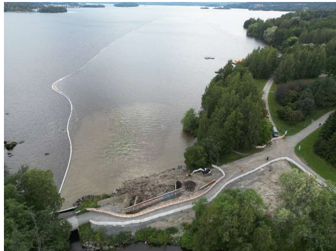
Kuva 10. Vasen kuva PK3 kuilulta rantaan tehdystä tuetusta kaivannosta ja oikea kannaksen kohdalta, jossa 110 kV sähkökaapeli on tuettuna. Huom! tässä kuvassa ei ole vielä silta asennettuna (kuvat: Ramboll CM / Henri Paasonen).
