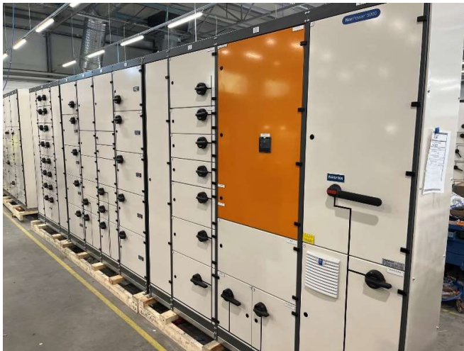
Kuva 6. Sähkökeskuksien mallikatselmus valmistajan tiloissa. (Kuva: Petri Ylönen)
